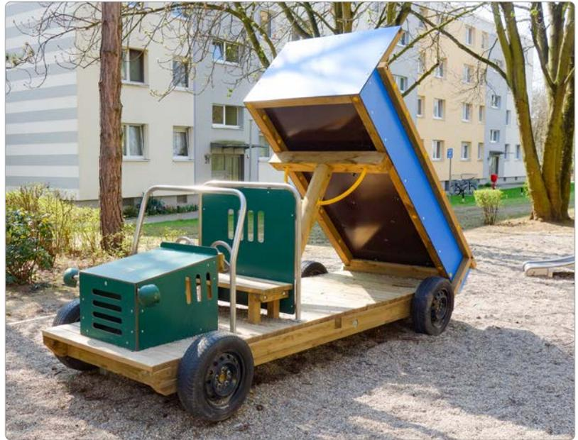
Beschreibung: Fahrgestell mit 4 Rädern aus glatten Altreifen, Hohlräume ausgeschäumt. Tragende Konstruktion aus Kanthölzern 9/17 cm, 4/11 cm, Rundholz Ø 16 cm, Kletterwand beim Kipper aus Siebdruckplatte, Aufbauten aus HPL-Platten, Überrollbügel aus Stahlrohr V2A, 1 Sitzbank, 2 Lenkräder, 2 Lichter.
