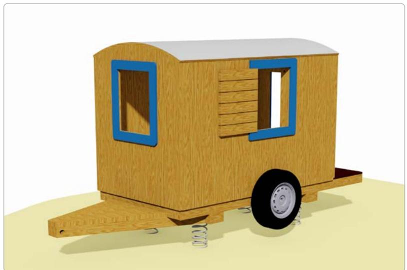
Beschreibung: Fahrgestell mit 2 Rädern aus Altreifen, Hohlräume ausgeschäumt. Tragende Konstruktion aus Kanthölzern 9/17 cm, 9/11 cm und 9/9 cm, Aufbau in Riegelwandkonstruktion, Wände aus Schichtholzplatten, Dach aus Dreischichtplatte mit verzinktem Blech und Abschlussprofilen an den Kanten, im Inneren des Bauwagens befindet sich 1 Tisch und 2 Bänke, Konstruktion ist auf 4 Federn schwingend gelagert. Aufständerung auf 4 Stk. Stahlfedern mit Tiefenankern.
