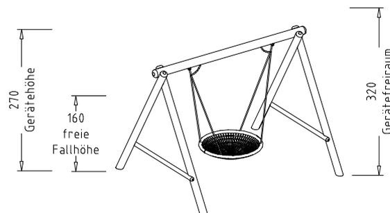
Beschreibung: 2 A-Stützen, 1 Schaukelbalken 3,50 m, 1 Schaukelkorb Ø 120 cm aus Gummigeflecht, mit Stoßdämpfung an den Stahlrohren, Original Vogelnest, 2 Abhängungen, 2 Sicherheitsketten.
