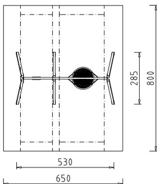
Beschreibung: 6 Stützen aus KH 11/11 cm, 4 davon schräg gestellt, 1 Schaukelbalken 4,60 m aus Stahlrohr 100/100/4 mm, verzinkt, mit Flanschplatten 8 mm für die Stützen, 3 Abhängungen, 2 Sicherheitsketten, 1 Original Vogelnest Ø 120 cm, 1 Sicherheitschaukel standard.
