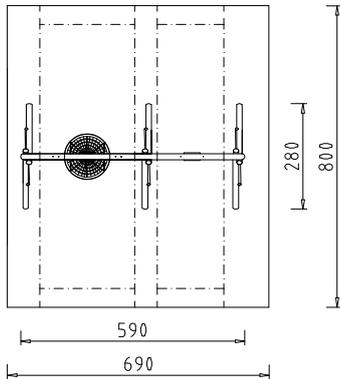
Beschreibung: 3 A-Stützen, 1 Schaukelbalken 5,90 m, 1 Schaukelkorb Ø 120 cm aus Gummigeflecht, mit Stoßdämpfung an den Stahlrohren, Original Vogelnest, 3 Abhängungen, 2 Sicherheitsketten, 1 Sicherheitschaukel standard.
