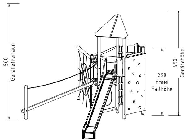
**Beschreibung:** 6 Steher, 4 Dreieckpodeste, 4 Handläufe, 1 Absturzsicherung für Rutschen, 1 Zwischenleiter, 1 Pultdach, 1 Bergsteigerwand, senkrecht, 1 U-Kletternetz, mit Feuerwehrstange, 1 Spinnennetz senkrecht mit Netzrahmen, 1 Balancierbalken-Aufstieg schräg, mit 1 Handlaufseil, 2 Spielwände standard, 1 Spielwand mit Schlupfloch, 2 Brüstungselement-Aufsätze.
