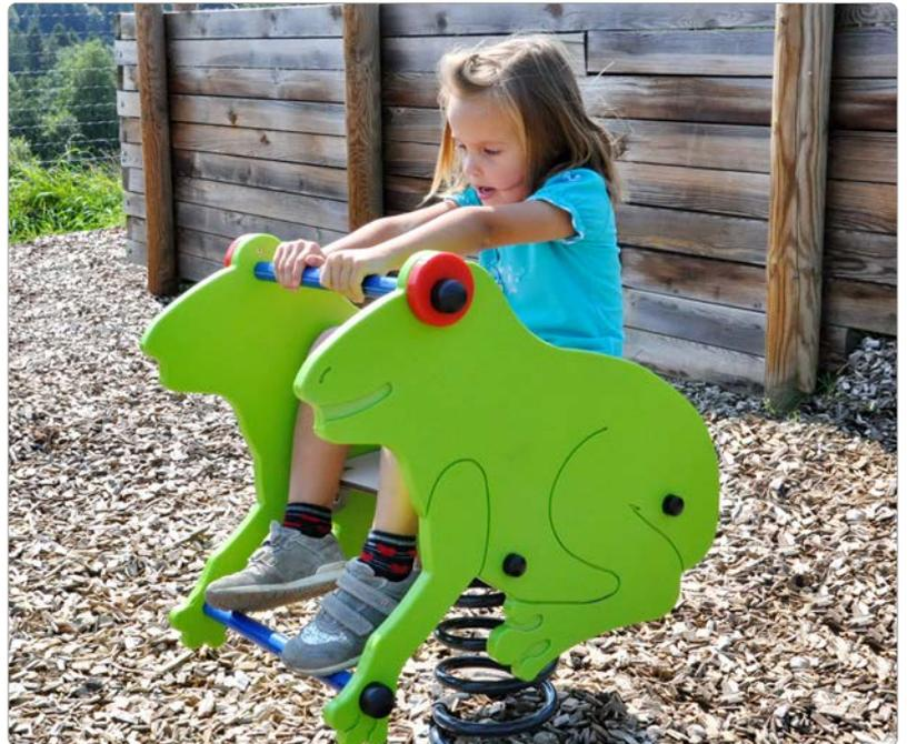
Beschreibung: Konturgefräste HDPE-Platten 19 mm, grün, 1 Sitz aus HPL-Platte 10 mm, grau, mit strukturierter, rutschhemmender Oberfläche, 2 Haltestangen aus Stahl mit Kunststoff Hüllrohr, 1 Feder Ø 17 cm mit 2 Federtellern, anthrazitgrau pulverbeschichtet.
