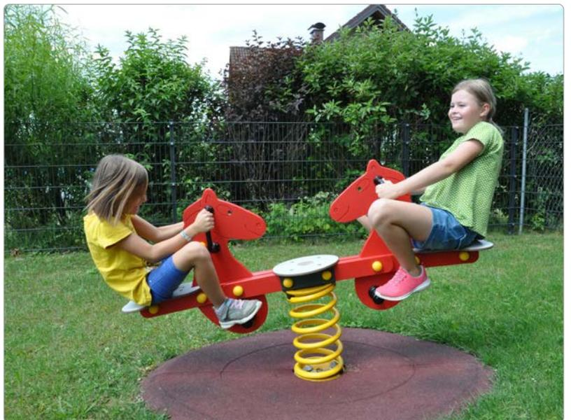
Beschreibung: Konturgefräste HDPE-Platten 19 mm, rot, 2 Sitze aus HPL-Platte 10 mm, grau, mit strukturierter, rutschhemmender Oberfläche, 4 Haltegriffe, 4 Fußrasten aus Polyamid, 1 Feder Ø 20 cm, mit 2 Federtellern gelb pulverbeschichtet.
