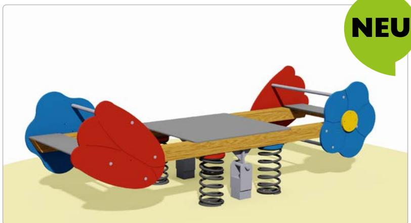
**Beschreibung:** 2 Wippbalken aus Kanthölzern 11/11 cm, 4 konturgefärbte HDPE-Platten 19 mm, 2 Sitzbänke und 1 Sitzfläche 100x94 cm mittig aus HPL-Platte 10 mm, grau, mit strukturierter, rutschhemmender Oberfläche, 2 Haltestangen und 2 Fußstützen aus Stahl mit Kunststoff-Hüllrohr, 4 Federn Ø 20 cm und je 2 Federteller gelb pulverbeschichtet, 2 Wippensteher mit Gelenk aus Formrohr 120/120 mm.
