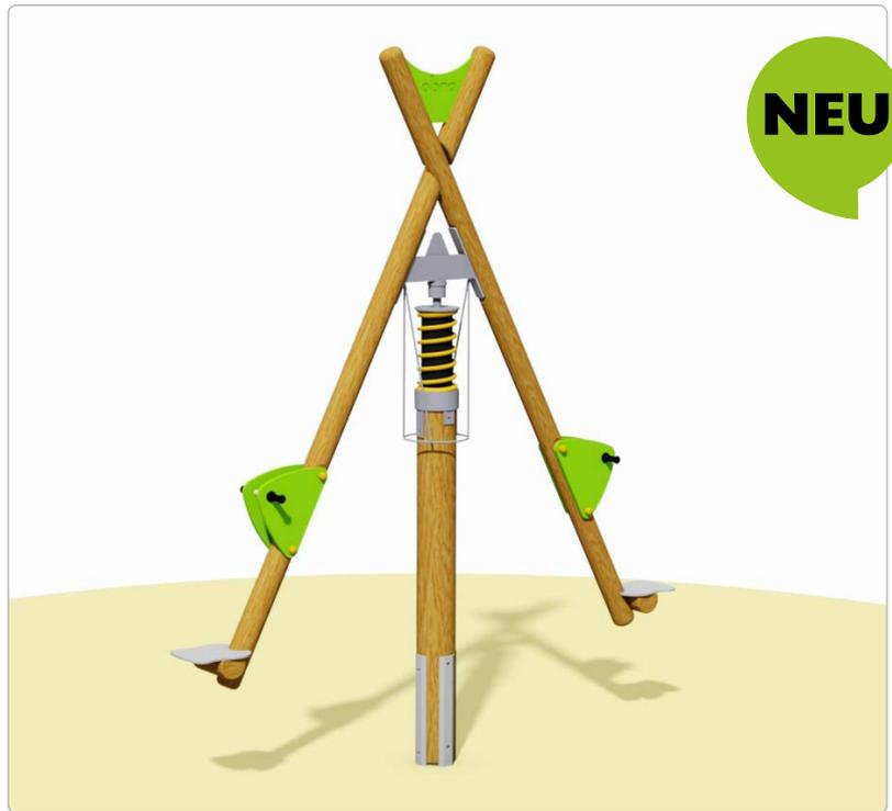
**Beschreibung:** 1 Pfosten (Steher) Ø 20 cm, Kernholz, 2 Wippbalken Ø 12 cm, 1 Feder Ø 20 cm mit 2 Federtellern, 1 Stahlträger aus Formrohr 120x120 mm mit angeschweißten Laschen, drehbar gelagert (Kugellager), 1 Befestigungshülse zum Steher, 2 Konsolen für Haltegriffe bestehend aus je 2 HDPE-Platten mit Distanzhülse, 4 Haltegriffe aus Polyamid, 2 Nutzerpositionen aus HPL 10 mm, mit rutschhemmender Oberfläche, 1 Sicherungsring an Ketten abgehängt, mitdrehend.
