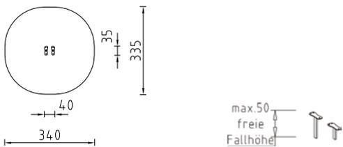
**Beschreibung:** 2 Stahlplatten in Fußform, mit Gummüberzug, 2 Stahlsteher (Pfosten), verzinkt.
