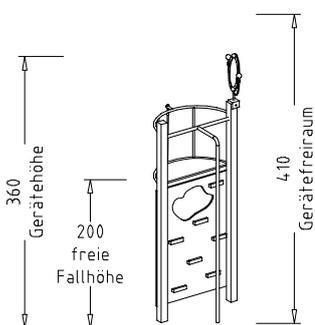
Beschreibung: 2 Steher aus Formrohr 100/100/4 mm, feuerverzinkt, 1 Balkon mit Boden aus Siebdruckplatte, 1 Herkules-Klettertau, 1 Feuerwehrstange, 1 Spiegel beweglich, aus Edelstahl, 1 Kletterwand aus Siebdruckplatte, 1 Seite mit Bergsteiger-Klettergriffen, 1 Seite mit Kletterleisten, verschraubt.
