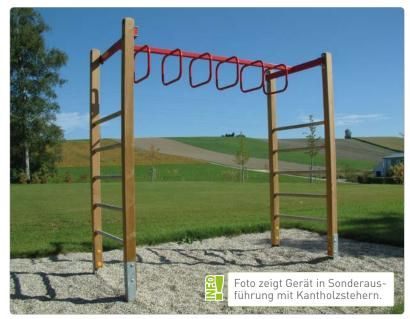
Beschreibung: 2 Aufstiegsleitern senkrecht, bestehend aus 4 Stehern (Pfosten), Rundhölzer Ø 12 cm, mit eingebohrten und verschraubten Sprossen, Esche Ø 4,5 cm, 1 Ring-Hangelbahn, mit angeschweißten Hangel-Bügeln, aus Rundrohr, Edelstahl. Aufständerung mit 4 Stk. Doppellaschen.
