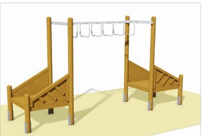
Beschreibung: 8 Steher (Pfosten), Rundhölzer Ø 12 cm, 2 MAXIMO Turmpodeste, aus je 2 Stahlwinkel, mit verdeckt geschraubtem Podestbelag 3,5/10 cm genutet, 4 Brüstungen schräg, 1 Ring-Hangelbahn, mit angeschweißten Hangel-Bügeln, aus Rundrohr, Edelstahl.
