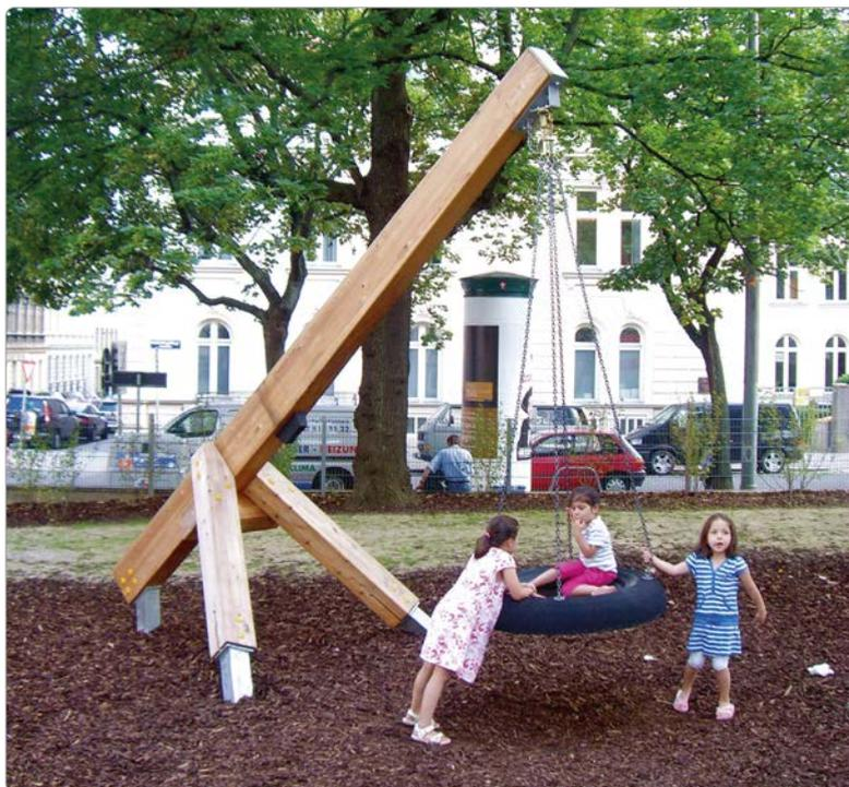
Beschreibung: 1 Schaukelbalken 18 x 36 cm, aus Leimholz, Lärche, natur, mit Aufprallschutz für Schaukel. A-förmige Anordnung der Stützbalken, 1 Reifenpendel, Schaukelabhängung mit Kreuzgelenk, Axial-Kugellager an 4 Ketten, 1 Sicherheitskette. Best.Nr. 45211 mit Nestpendel anstatt Reifenpendel. Aufständerung mit 3 Stk. Stahlschuhe.
