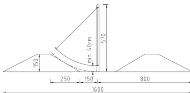
Beschreibung: 2 Steher (Pfosten) Ø ca. 20 – 25 cm, 7 m lang, 1 Schaukelbalken Ø 20 – 25 cm, 5 m lang, 2 Stahlwinkel mit Knotenblech zur Befestigung des Schaukelbalkens auf den Stehern, 1 Schwingseil mit Doppelknoten, 2 Pendelsitze an Ketten, mit Schutzschlauch, abgehängt an 3 Schaukelgelenken, Schrauben Edelstahl.
