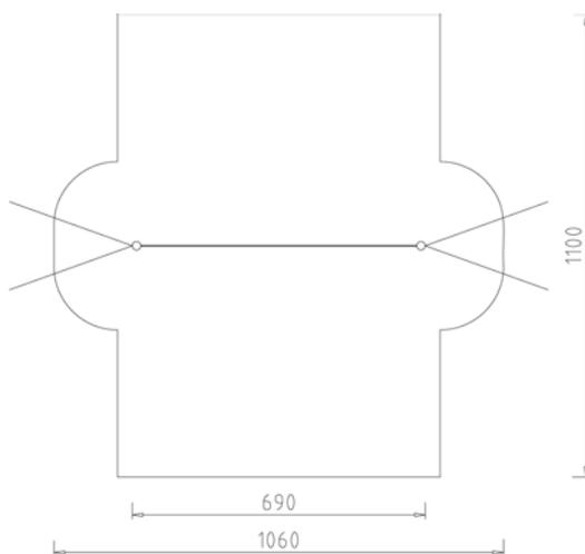
Beschreibung: 2 Steher (Pfosten) Mindest  $\varnothing$  20 cm, unten mit je 1 Pendelstützen-Lager, je 2 Spannseile, mit Stahlanker, zum Einbetonieren, Querseil in Herkules-Machart, mehrlitzig, kunststoffummantelt, 3 Schaukel-Schwingseil-Gelenke, bestückt mit 1 Knotentau, 1 Schwingseil, 1 Pendelsitz an Schwingseil, Schrauben Edelstahl.
