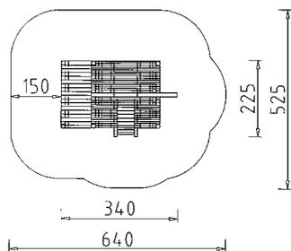
Beschreibung: Kanthölzer, kernfrei, Sparren 9/11 cm, Querhölzer 9/9 cm, Bodenbelag 4/11 cm, Dachschalung 20 mm stark, genietet, 6 Rundsteher Ø 12 cm, oben gerundet, kernfrei, 1 Klettertau, Stahlseil, kunststoffummantelt Ø 22 mm, mit Bodenanker unten, Kausche und Preßklemme in Alu, oben.
