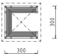
Beschreibung: Pavillon komplett mit vorgefertigten Einzelteilen, Dach-Teilen, Sitzbänken sowie Bodenverankerungen. Dacheindeckung mit gerollten Brettern, auf Wunsch mit Bitumen-Dachschindeln, oder mit verzinktem Blech.
