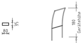
Beschreibung: Stahlrohrrahmen Ø ca. 35 mm, Edelstahlblech mit Rundrohrrahmen verschweißt, eine Seite konkav, andere Seite konvex. Durch die Biegung der Spiegelfläche werden Zwerge zu Riesen und Riesen zu Zwergen.
